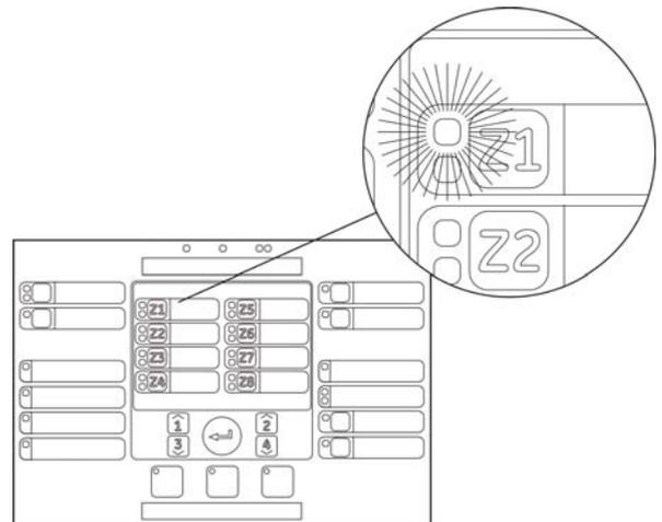
Si la LED Alarme feu et la LED d'alarme de zone clignotent, l'alarme incendie a été activée par un détecteur. Si elles sont fixes, l'alarme incendie a été activée par un bouton-poussoir d'alerte.
