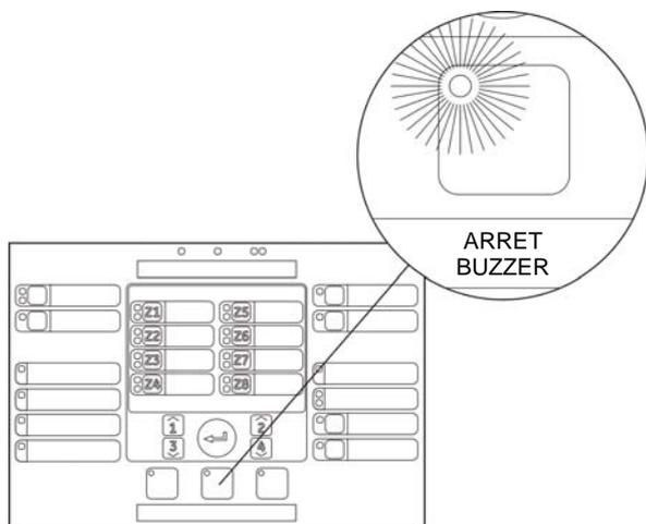
La LED Arrêt buzzer s'allume et le buzzer s'arrête. De nouveaux événements d'alarme ou de dérangement réactiveront le buzzer.
